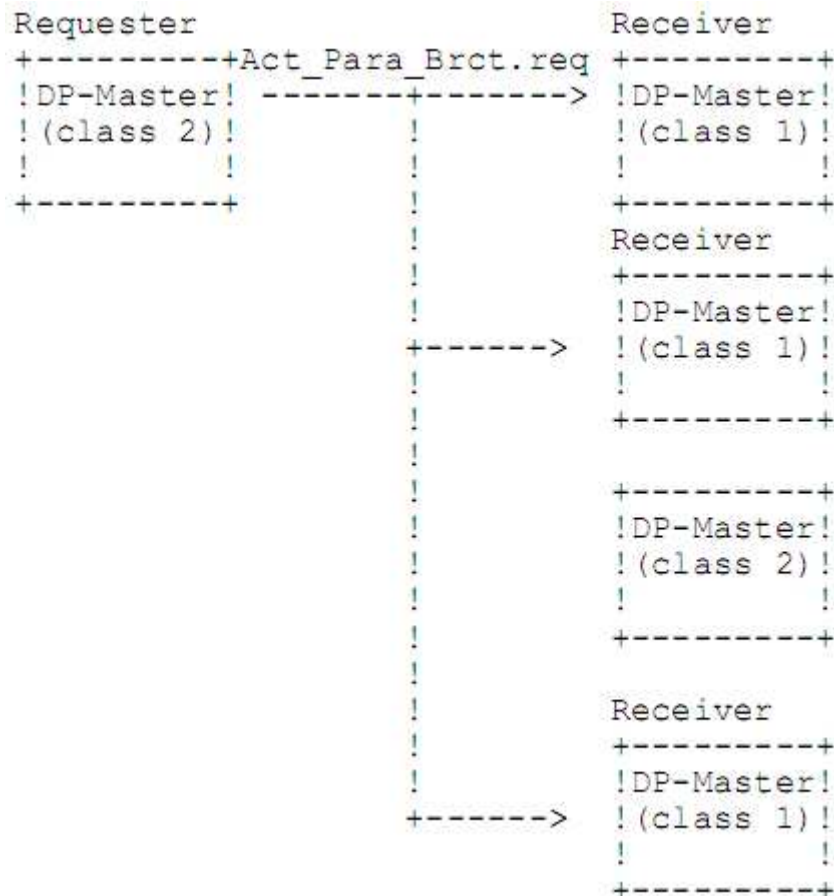
Rys. 6. Komunikacja Master-Master, jeden do wielu, funkcja DDLM_Act_Para_Brct
